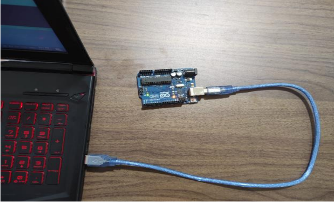
Gambar 4.42. Menghubungkan Arduino Uno R3 dengan Laptop Menggunakan Kabel USB
