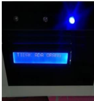
Gambar. 11. Tampilan LCD Saat Tidak Ada Orang Yang Terdeteksi
