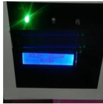
Gambar. 13. Tampilan LCD Saat Ada Orang Yang Keluar Rumah Menggunakan Masker
