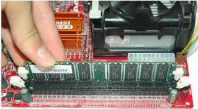
Gambar 9.5 Pemasangan Memory RAM
