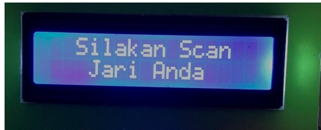
Gambar 5.7 Tampilan LCD 16x2 Untuk Melakukan Scanning Sidik Jari
