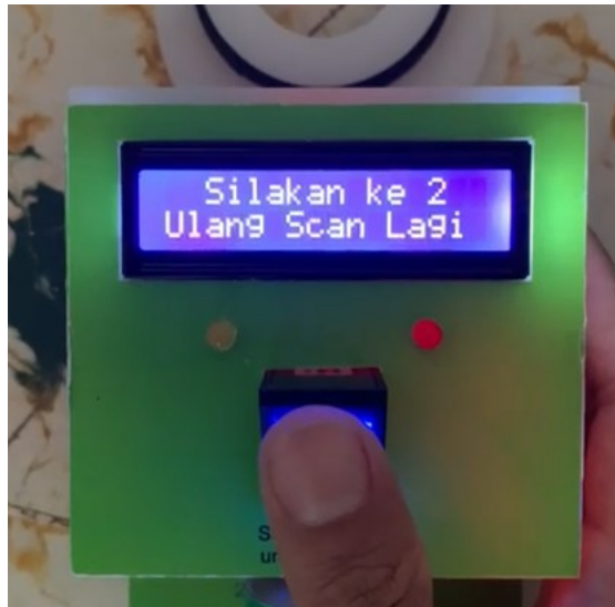
(b) LCD 16x2 Menampilkan Informasi Untuk Melakukan Proses Scanning
