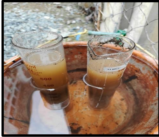
Gambar 4.2 Pemeriksaan berat jenis dan penyerapan air agregat halus (Sumber : Dokumentasi Laboratorium, 2025)
