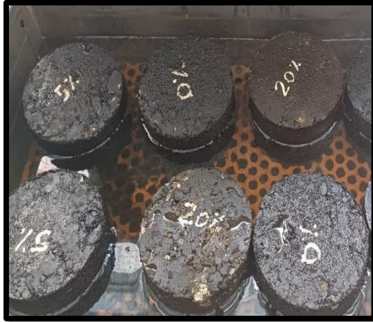
Gambar 4.12 Sampel Kadar Aspal Optimum (Sumber : Dokumentasi Laboratium, 2025)
