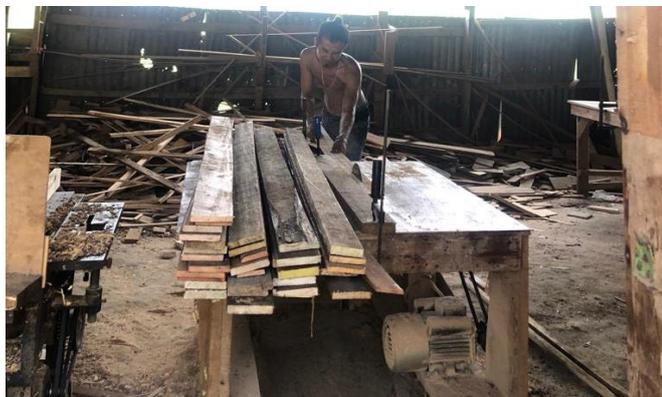
Gambar 1.1 Kondisi Pekerja yang Tidak Aman Dalam Melakukan Pekerjaan dan Kurangnya Mesin yang Tidak Memadai Keselamatan pada SK Pemoangan (Sumber: CV Cahaya Furniture, 2023)
