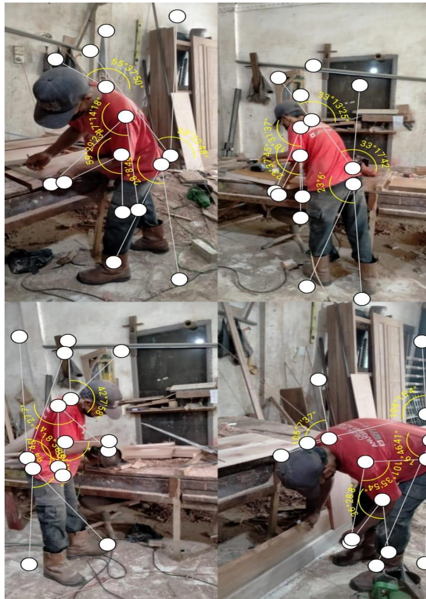
Gambar 1.1 Postur kerja Operator Pada Pembuatan Pintu Kayu (Sumber: Dokumentasi Penulis, 2023)
