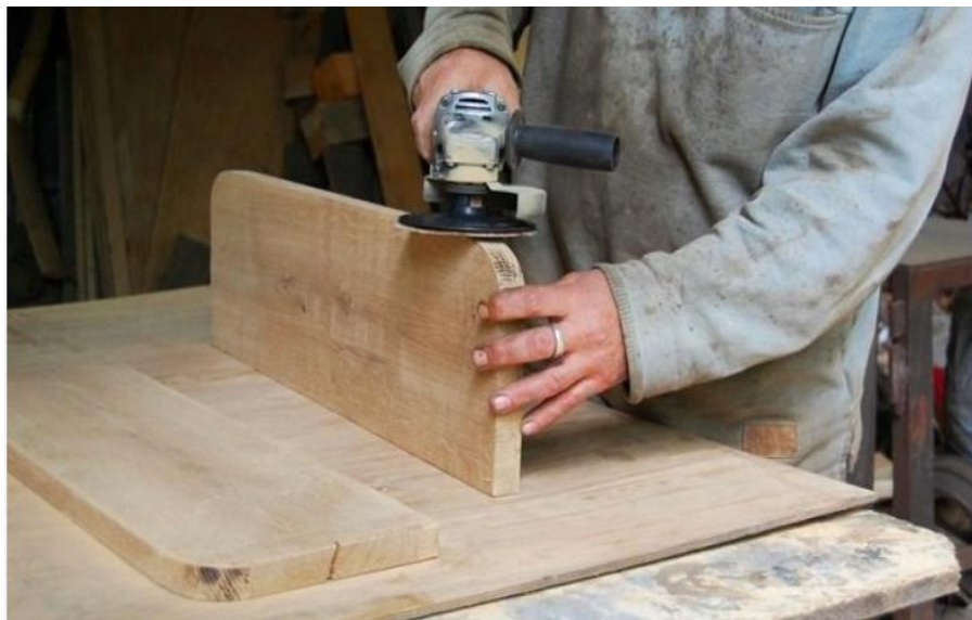
Gambar 1.4 Proses Pengamplasan Kayu (Sumber: Dokumentasi Penulis)
