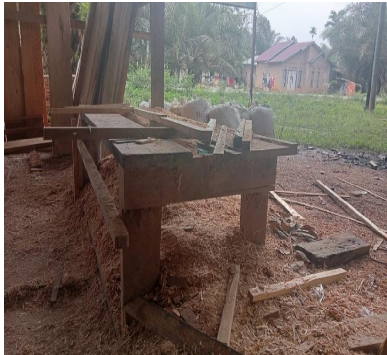
Gambar 1.1 Meja Bantu Proses Pengetaman (Sumber: Dokumentasi Pribadi, 2023)
