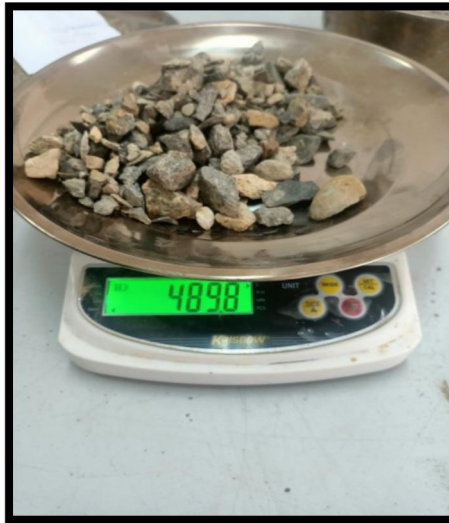
Gambar 4.8 Sampel agregat halus setelah direndam dan dioven
