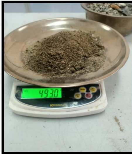
Gambar 4.7 Sampel agregat halus setelah direndam dan dioven
