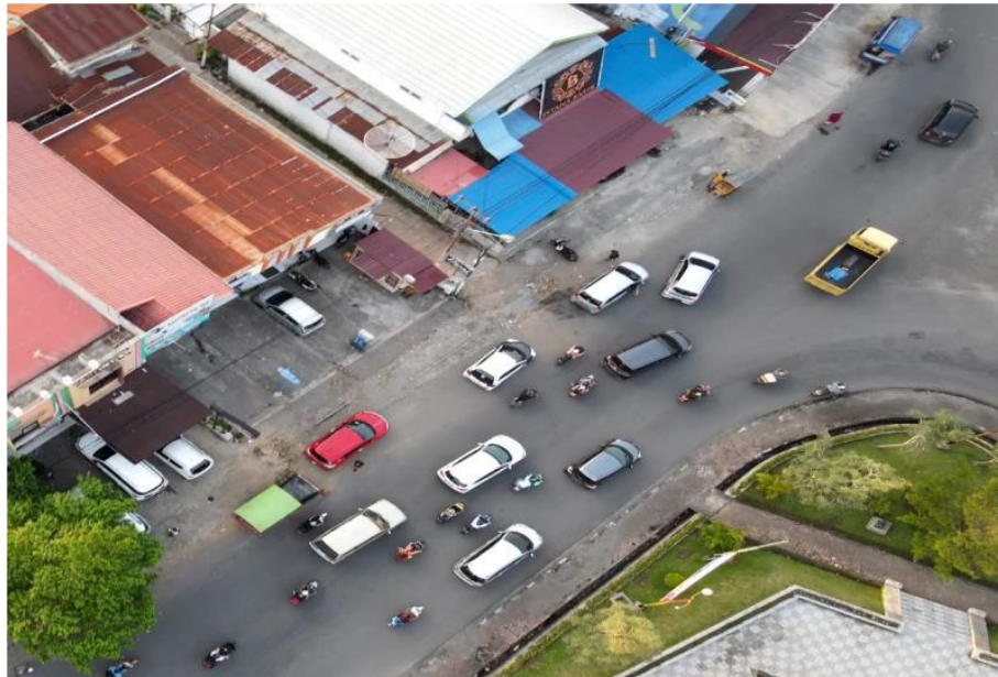
Gambar 1.1 Penyempitan jalan akibat kendaraan parkir di bahu jalan
